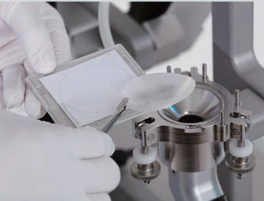
这种直接提取颗粒物的方式适用于表面积比较小、颗粒物量不太大的工件，例如电路板、工件传递环境等等，颗粒物提取过程很快，对于加工过程的干扰可以降低到最小。
