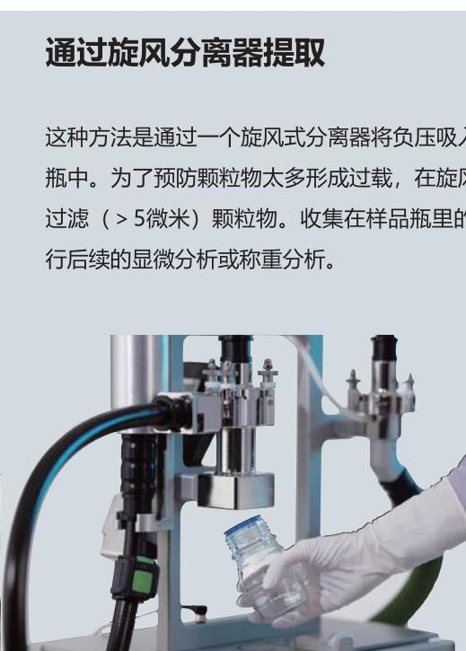
采用旋风式分离器一般适用于颗粒物比较多的大型零部件。与传统的“湿法”提取相比，这种无损提取方法既经济又高效，省却了大量液体介质消耗，减少了物流费用而且检测区域易于划分和隔离。
